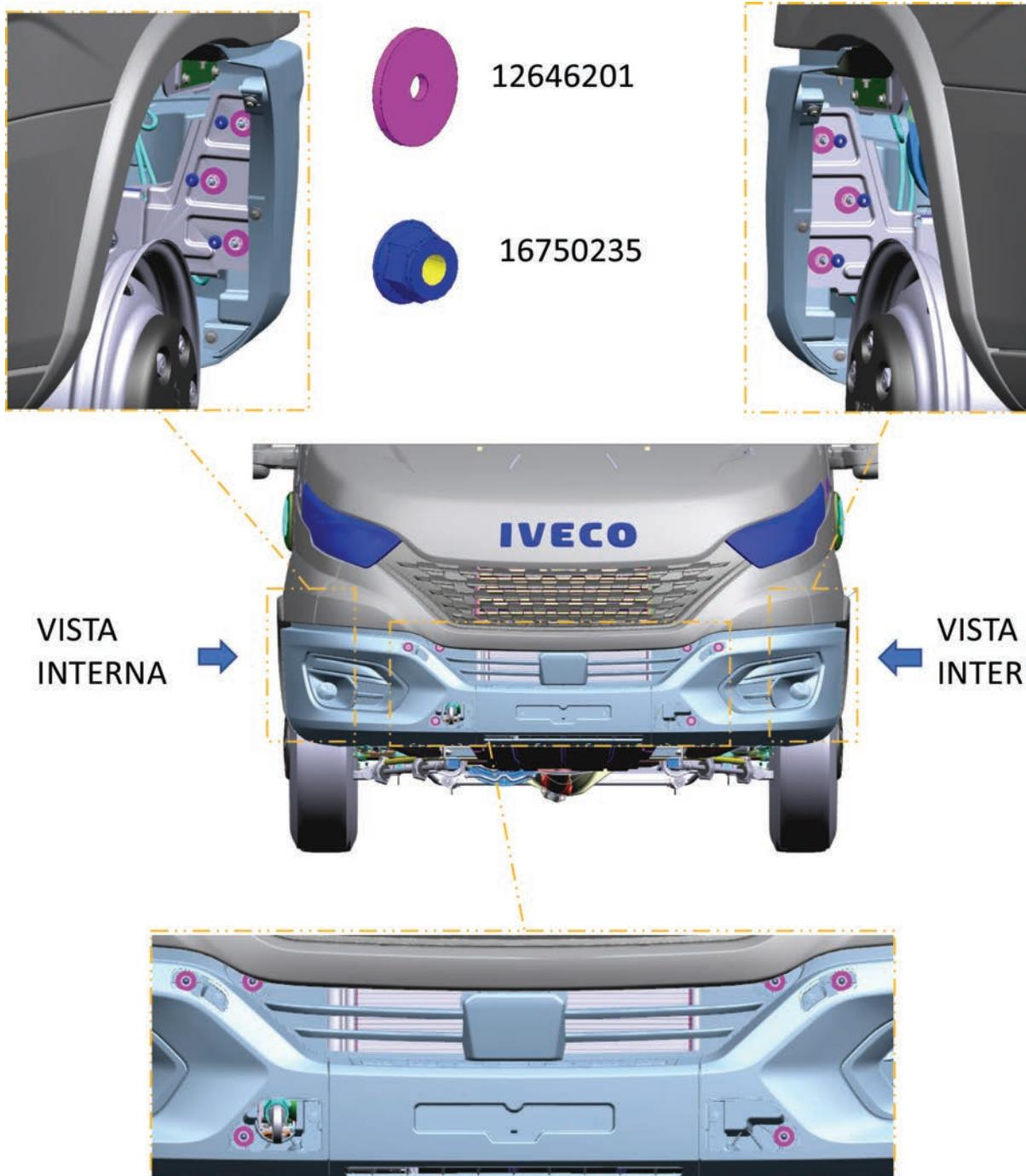
3. Após fixação das porcas, seguir sequência de montagem, aplicando o torque primeiramente o lado direito, obedecendo a altura MÍNIMA de 27 mm. (Fig. 1)
