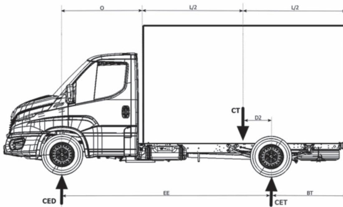
Na construção da carroceria, o implementador leva em conta o centro de gravidade de todo o conjunto (caminhão + carroceria) para garantir o equilíbrio, a segurança do veículo ao trabalhar e a distribuição de carga por eixo.
