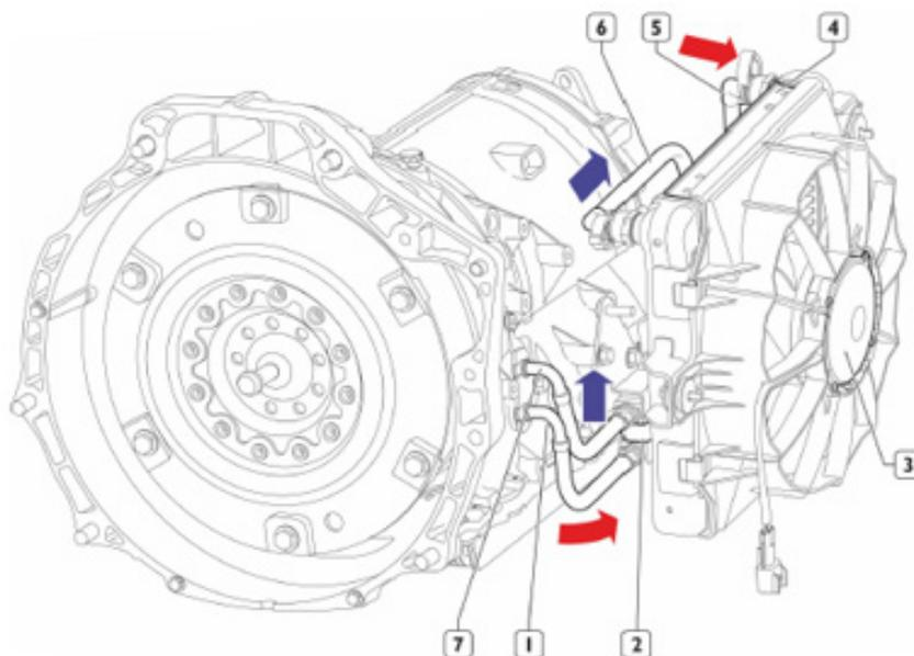
1. Tubos de saída de óleo quente da caixa de velocidades para a válvula termostática
