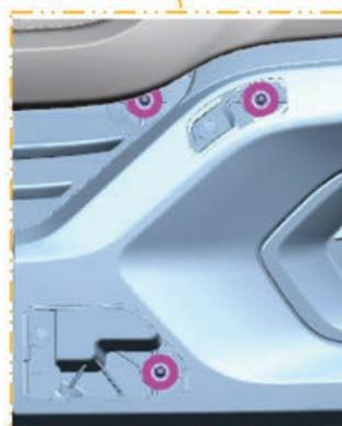
6. Aplicar o torque no lado esquerdo, conforme informação de torque no quadro abaixo, obedecendo a distância MÍNIMA de 27 mm da altura entre a face superior do para-choque com a face inferior do acabamento frontal (Fig. 1).
