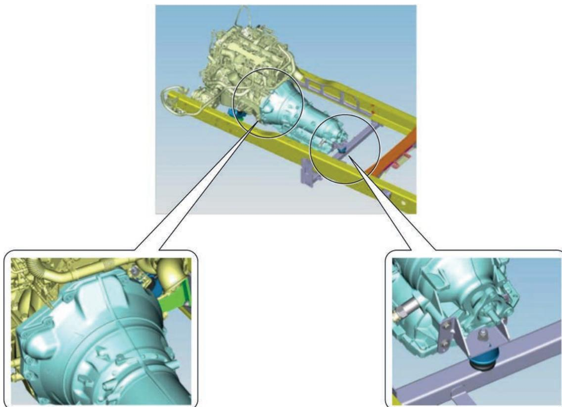
Algumas especificidades técnicas fundamentais (motor, veio de transmissão, cabo do capot e cabo do painel de instrumentos, sistema de refrigeração adicional para a caixa de velocidades) e a necessidade de submeter o veículo a re-homologação tornam praticamente impossível a conversão de uma caixa de velocidades manual em caixa de velocidades automática, a menos que o “Power Pack” (unidade do motor/caixa de velocidades) seja completamente substituído.
