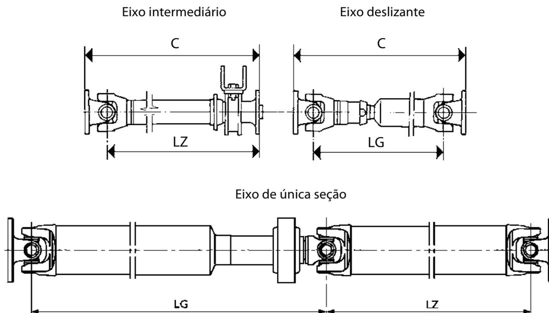
O comprimento (LG) dos eixos deslizantes deve ser medido entre os centros de acoplamento quando o segmento deslizante estiver na posição intermediária.
