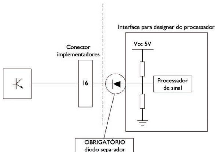
O implementador deve instalar um diodo separador de maneira que não haja queda na tensão VON.
