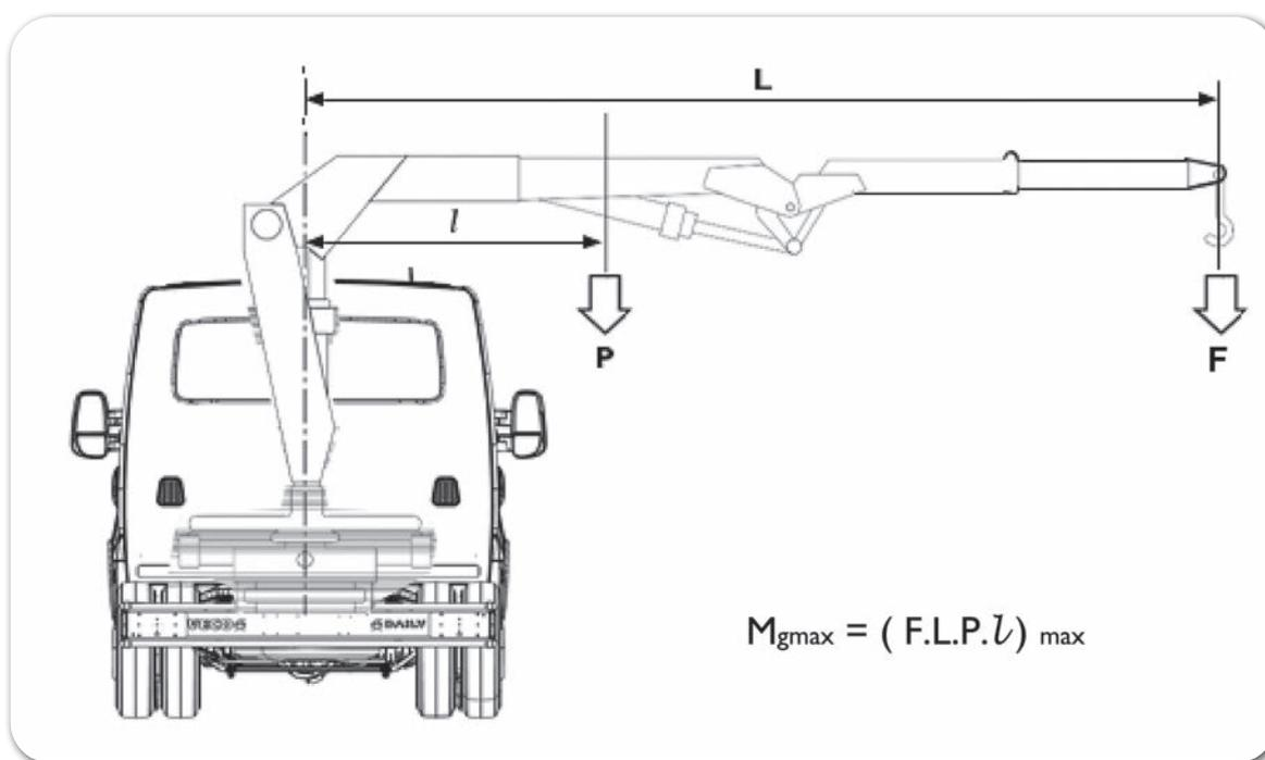
As dimensões do chassi auxiliar referem-se ao momento máximo estático total da grua ( $M_{gmax}$ ), que é calculado com base da equação dada na figura acima.
