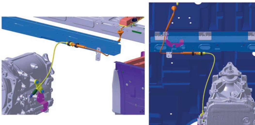
Para manter a eficiência (desempenho) do sistema de desbloqueio, o comprimento do cabo Bowden deve permanecer inalterado, mesmo que sejam necessários novos pontos de fixação e um novo percurso.
