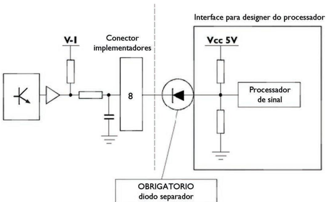
O implementador deve instalar um diodo separador de maneira que não haja queda na tensão VON.
