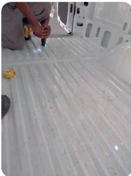
As limalhas de aço provenientes das furações devem ser retiradas. É recomendado que sejam retiradas utilizando um aspirador para garantir que o salão fique limpo. É necessário que todos os furos realizados sejam tratados para evitar oxidação, é recomendado o uso de primer de tratamento do tipo Wash Primer, indicado como promotor de aderência e protetor anticorrosivo para preparação de superfícies ferrosas metálicas e não ferrosas.
