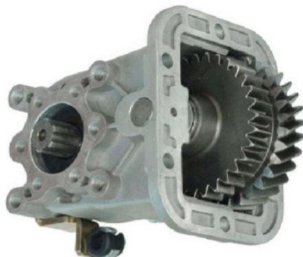
Tomada de força, também conhecida pela sigla **PTO** (do termo na língua inglesa power take-off) é um eixo propulsor, disponível em maquinário pesado, usado para transferir força mecânica do motor a um implemento instalado. Diferentes tipos de **PTO** podem ser usados dependendo do tipo de uso e os desempenhos requeridos.
