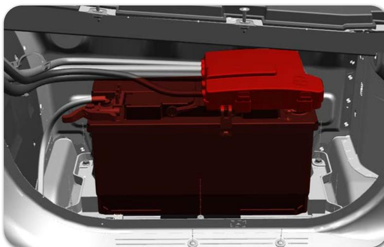
Bateria posicionada no compartimento debaixo do assento do motorista. Em caso de movimentação ou substituição da bateria, atentar que ela deve permanecer sempre com um tubo “mangueira” conectado à saída de gases do lado (direito) do polo positivo.
