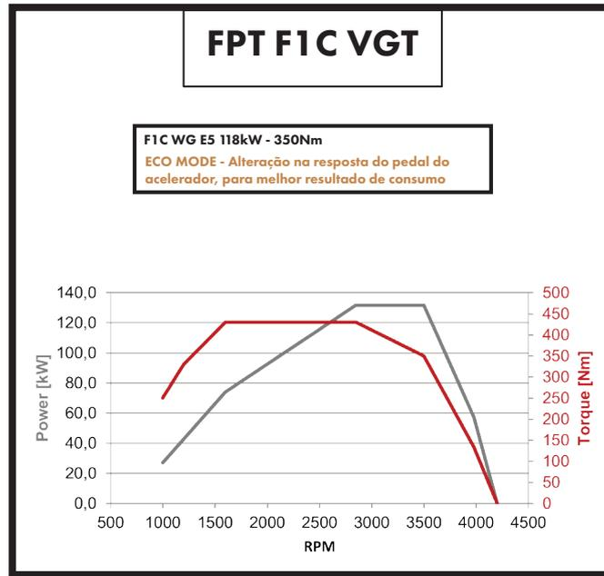
132kW(180hp)@3500rpm / 430Nm@1600rpm:
