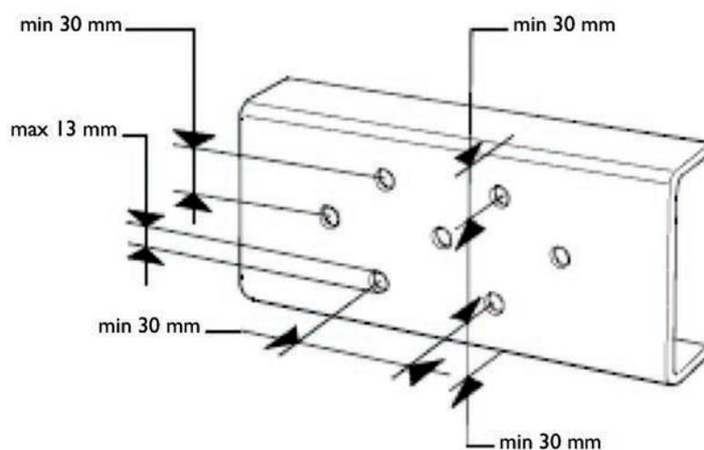
Na realização de novos furos, no caso de proximidade excessiva com os já existentes, podem-se fechar esses últimos mediante solda. Para que a operação tenha sucesso, chanfrar a borda exterior do furo e utilizar para a parte interior uma placa de cobre.
