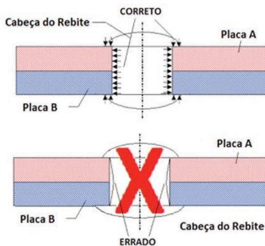
Antes do uso de um rebite para fixação de componentes, analise previamente a aplicação deles, considerando eventuais necessidades de remoção do componente para reparos e possíveis substituições.
