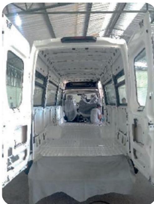
Será necessário a elaboração de gabaritos para realizar os furos da carroceria para garantir o posicionamento e repetibilidade das furação dos sistemas listados abaixo:
