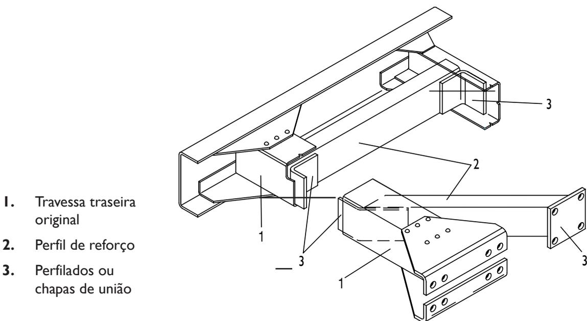
1. Montagem de um perfil quadrado adequadamente dimensionado embaixo da travessa, ancorado nos extremos do costado vertical das longarinas e fixado à travessa em sua parte central, tal como indicado na figura a seguir.
