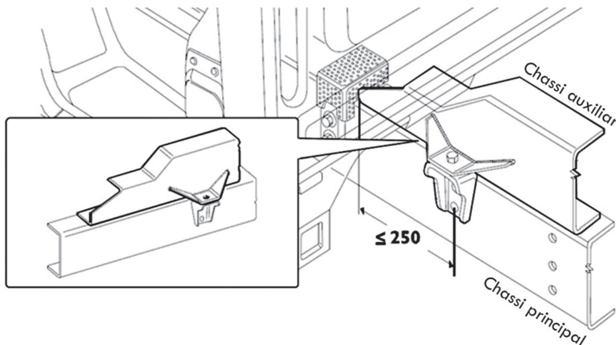
A distância entre o primeiro ponto de fixação (chassi principal + chassi auxiliar) e a extremidade dianteira do chassi auxiliar deve ser menor ou igual a 250 mm de acordo com a figura anterior.
