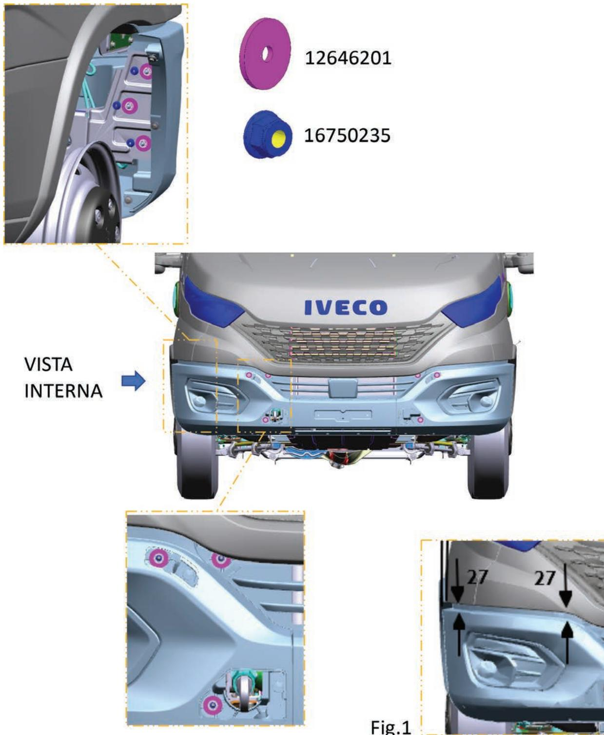
4. Aplicar o torque no lado direito, conforme informação de torque no quadro abaixo, obedecendo a altura MÍNIMA de 27 mm da altura entre a face superior do para-choque com a face inferior do acabamento frontal. (Fig. 1)
