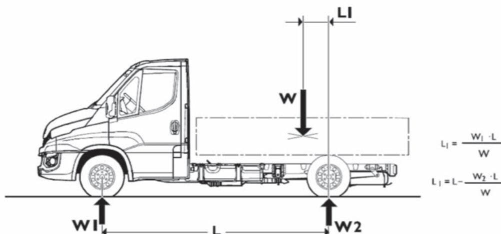
$W$  = Equipamento + carga útil (kg)
