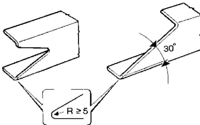
Se os componentes da suspensão traseira da cabine (ou outro instrumento instalado entre a cabine e o chassi auxiliar) não permitirem a secção transversal completa do chassi auxiliar, proceda como a seguir:
