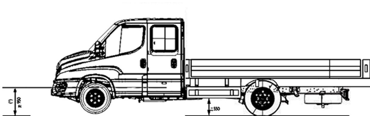
(\*) Com a parte inferior do corpo ao longo dos 1300 mm do chão ou com a largura do corpo a menos do que a dimensão externa dos pneus.
