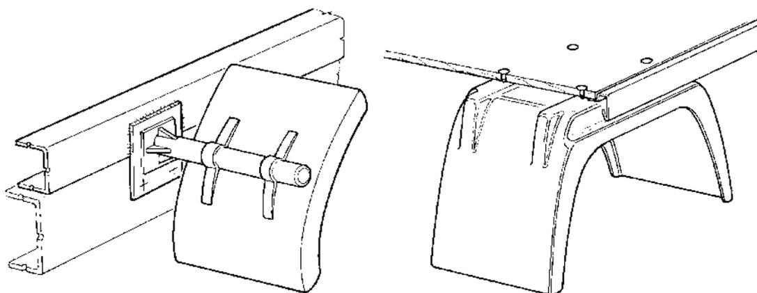
Para evitar a eventual interferência entre as rodas e seu alojamento e para assegurar a correta ventilação dos freios, os vãos de rodas devem manter uma distância mínima de 50 mm em relação à posição de deslocamento máximo da roda.
