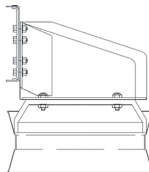
Para limitar os esforços torcionais sobre o chassi do veículo, aconselhamos efetuar a instalação do suporte da roda sobressalente contando com uma travessa, especialmente quando se tratar de grupos de peso elevado. Da mesma maneira deve-se atuar na instalação de grupos suplementares como tanques, compressores, etc.
