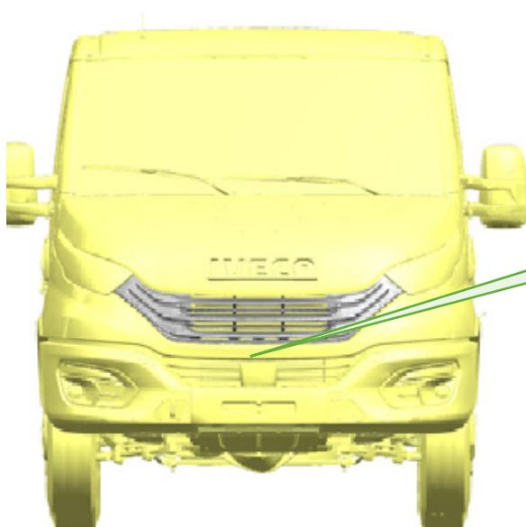
A abertura frontal para a passagem de ar para o sistema de arrefecimento deve ser de no mínimo 25 dm<sup>2</sup> com largura não inferior à do radiador.
