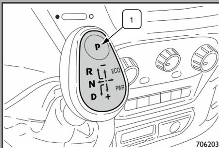
Se o veículo permanecer parado no período de 5 segundos, o estado 'Parking' é engatado; caso contrário, a mudança permanece em 'N' e o comando é cancelado. Neste ponto é necessário selecionar novamente o comando desejado. Se o estado 'P' for necessário a uma velocidade superior a **3 km/h**, a caixa de velocidades engata o estado 'N' (aparece a letra 'N' fixa no display e na alavanca).
