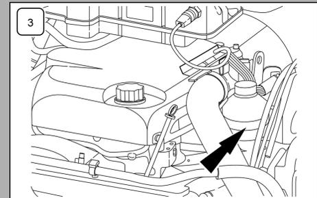
4. Verificar o nível do líquido do reservatório do lavador dos vidros.
