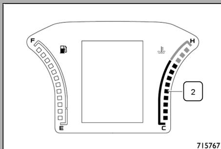
Quando o painel de instrumentos é ligado com a chave em (MARI), no display do quadro de bordo são exibidos dois gráficos de barras que indicam a quantidade de combustível presente no tanque e a temperatura do líquido de refrigeração do motor.
