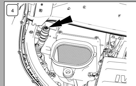
Verificar ainda que os tubos não se encontram obstruídos; se necessário, limpe os pulverizadores com uma agulha.
